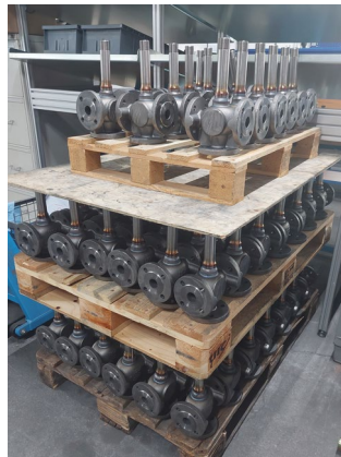
Unlackierte 342-2-BK-SS Ventile aus Sphäroguss
